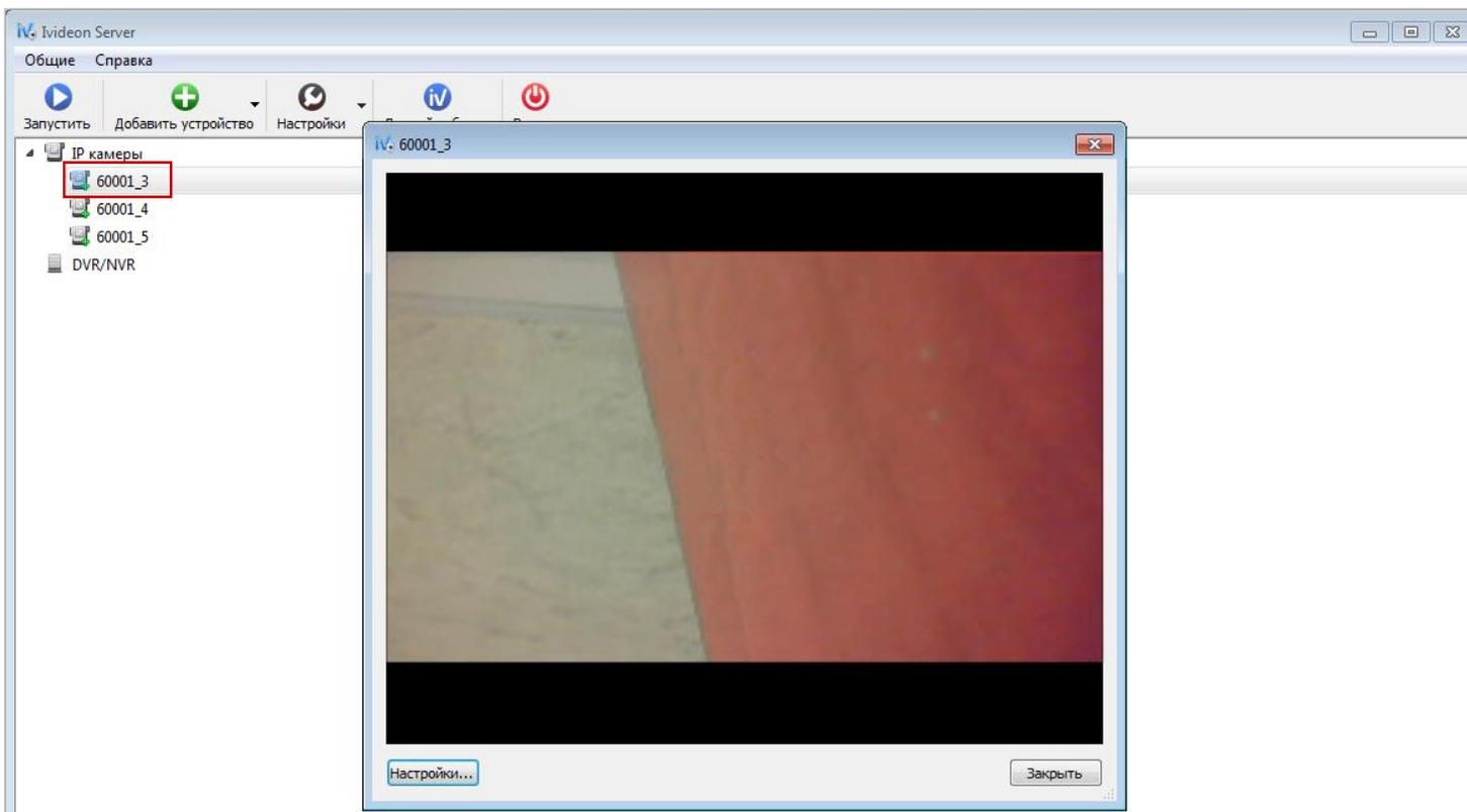
При самостоятельной проверке подключения камер к Вашему аккаунту на ресурсе [ru.ivideon.com](http://ru.ivideon.com) одновременно можно протестировать **не более одной камеры**. Поэтому при запуске камер необходимо использовать поочередно только одну камеру.
